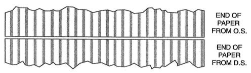
WHEN THE MARKS MADE BY THE FLUTE TIPS ON THE DUPLICATING PAPER ARE ALIGNED, THE ROLLS ARE PARALLEL.
